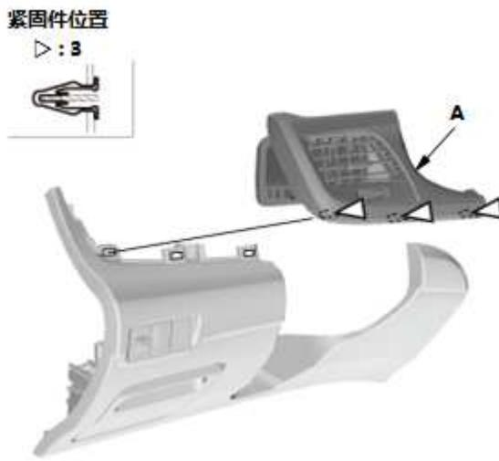
2. 如有必要, 拆下螺钉, 然后拆下出口下板 (A)。
